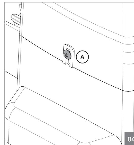
Während der Installation müssen Sie die Motorabdeckung öffnen, um an verschiedene Komponenten im Inneren zu gelangen. Hierzu lösen Sie leicht die 2 angegebenen Schrauben (A), bis Sie die Motorabdeckung abnehmen können.
